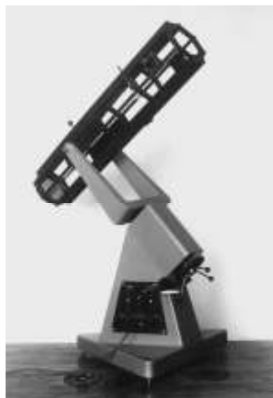
Vyrobený dalekohled typu Newton o průměru 160 mm a ohniskové vzdálenosti 1200 mm
