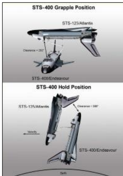
Vzhledem k tomu, že Atlantis neletěl k ISS, Grafická simulace případné záchranné mise. Nahoře je zobrazeno spojení obou raketoplánů. Dole zachyceno natočení raketoplánů během přestupu astronautů do druhého plavidla.
