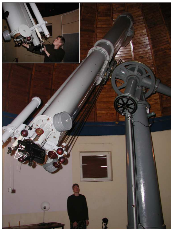
Dvojitý refraktor (360/5440 mm a 300/5130 mm) na pracovišti Hoher List v Německu
