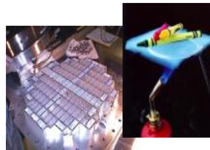
Vlevo: Výklopná mřížka, v níž jsou destičky aerogelu. Vpravo: Aerogel má vynikající vlastnosti. Snímky převzaty z internetu
