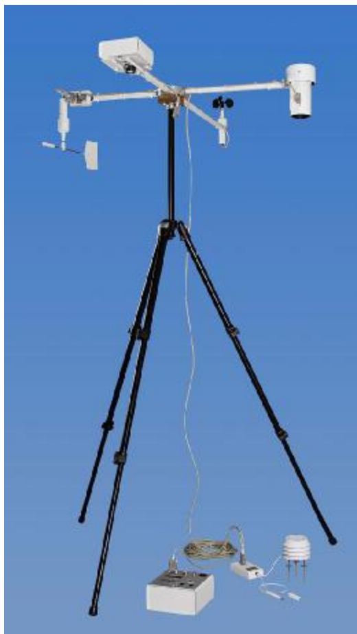
Kompletní sestava meteorologická stanice (s provizorním stativem) viz článek na str. 3
